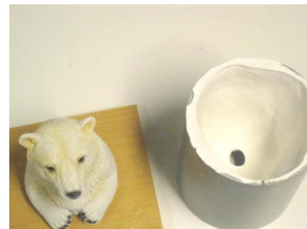
Fig. 9: Het gips en de plasticine is verwijderd en het model is weer goed schoon gemaakt.
